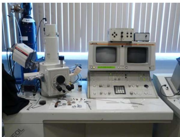
Figura 12. Fotografía del microscopio electrónico de barrido JEOL JSM-5300.
