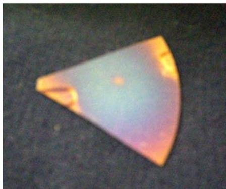
Figura 22. Substrato típico de silicio (111) con depósito de película de  $AlN$ .
