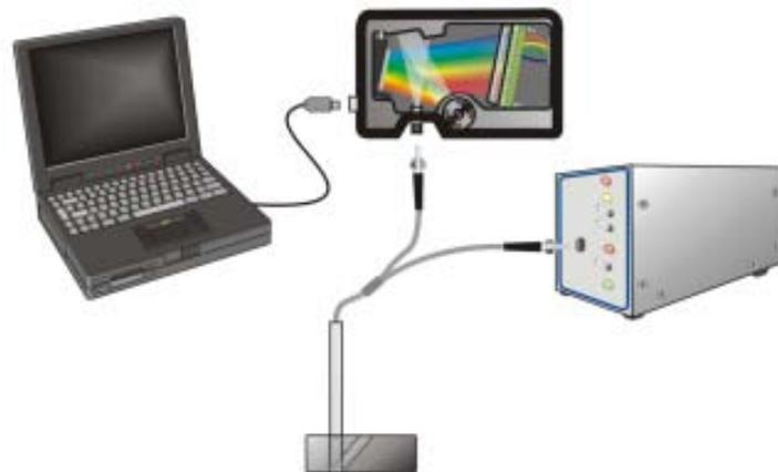
Figura 19. Esquema del sistema de medición de espectros de reflectancia.
