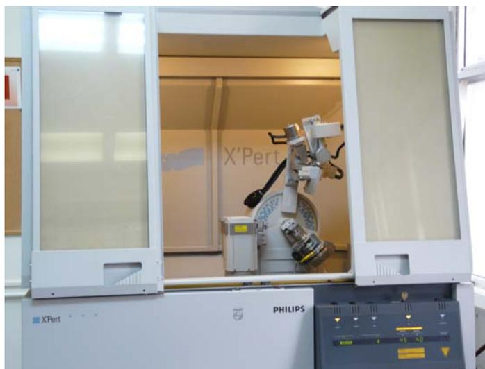
Figura 16. Fotografía del difractómetro de rayos X marca Phillips modelo X'Pert-MED.
