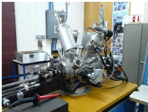
Figura 20. Equipo SAM-PHI 595 para análisis de AES y perfiles de concentración.
