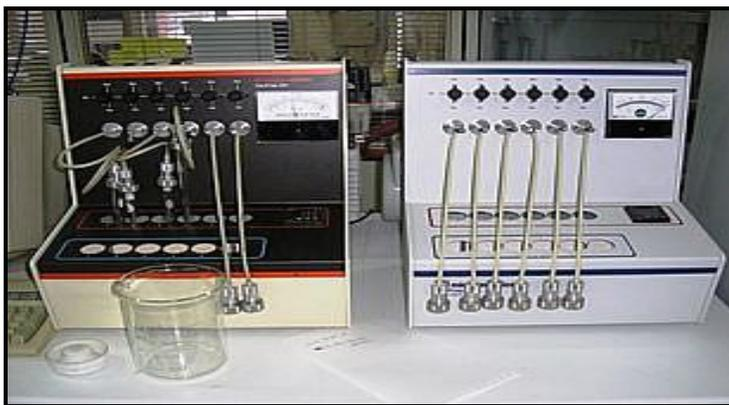
**Figura 9. Accesorio de degasificación Micromeritics.**
