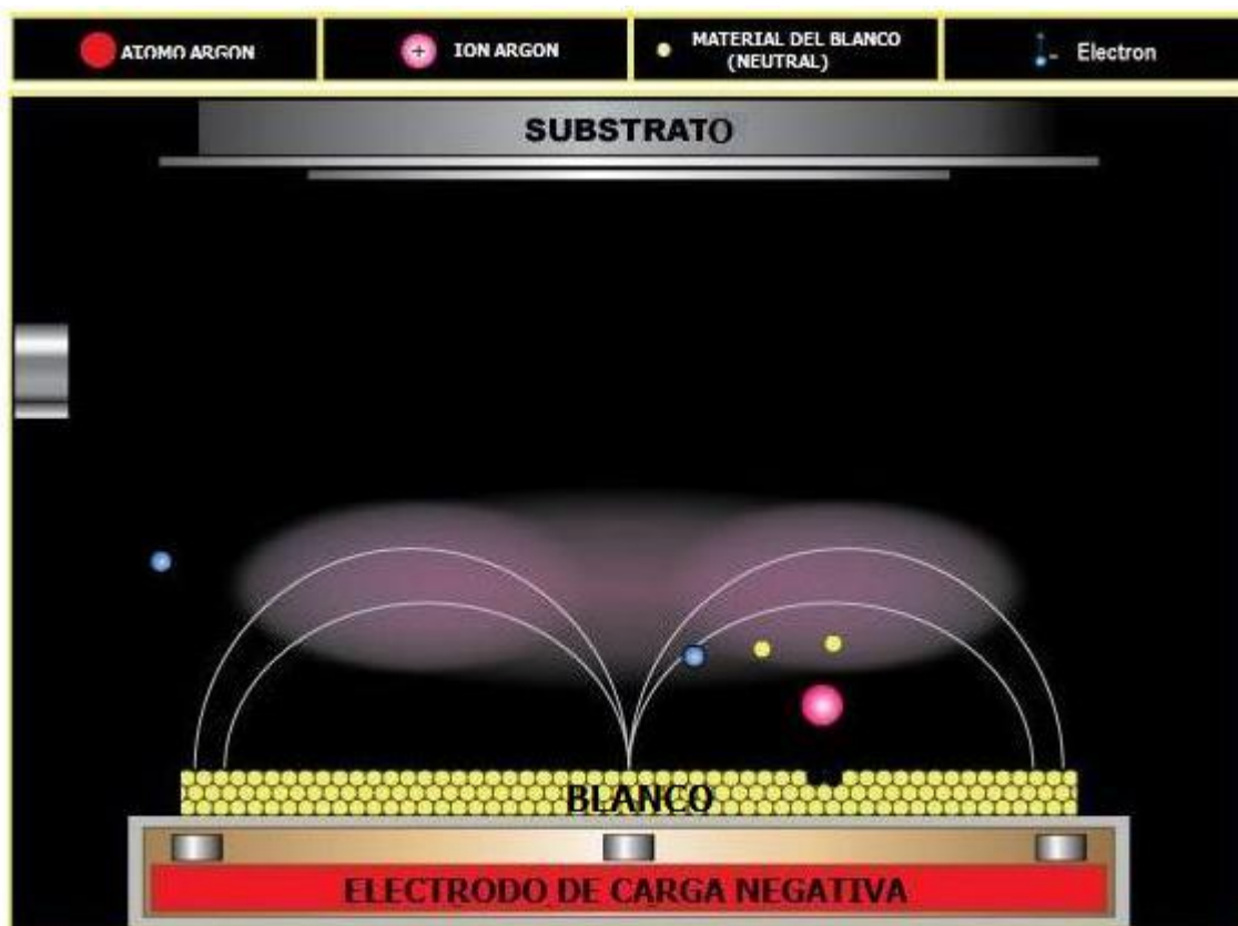
Figura 14. Esquema de un dispositivo de erosión iónica tipo magnetrón en régimen de RF.
