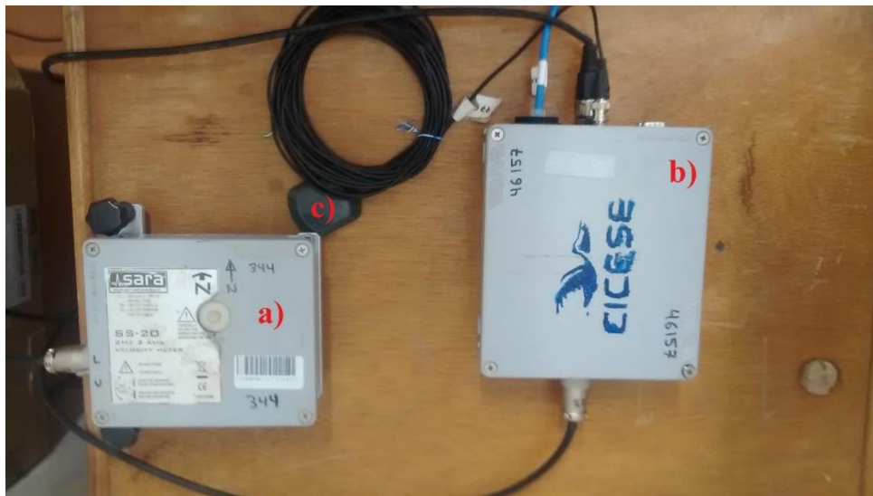
Figura 10. Instrumentación usada. Sensor (a), digitalizador (b) y antena GPS (c).
