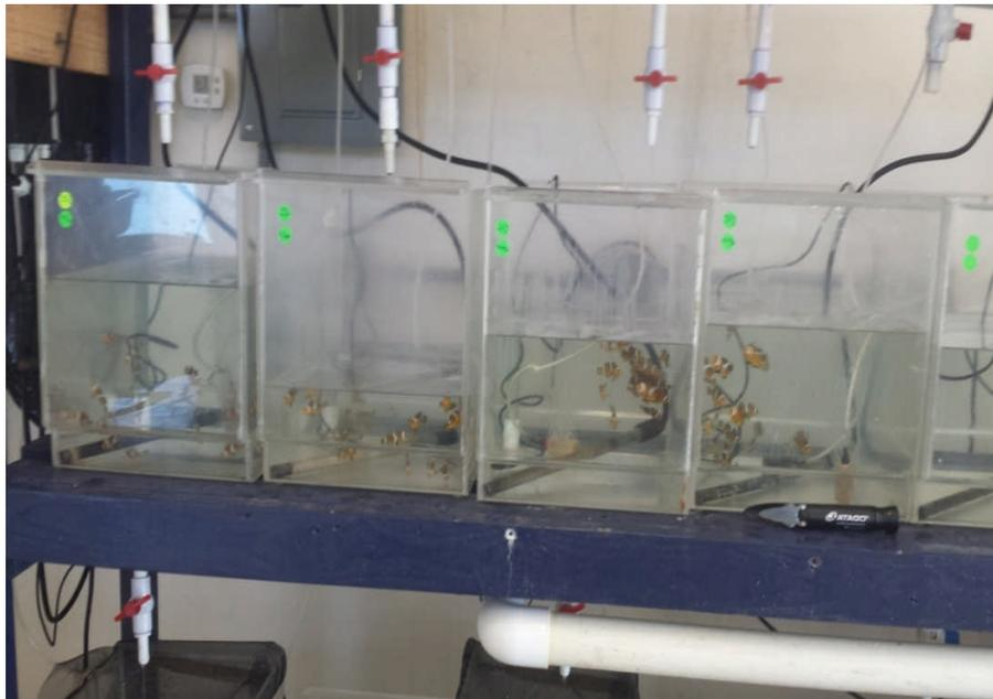
**Figura 5.-** Sistema utilizado para aclimatar y mantener a los organismos en las salinidades experimentales.
