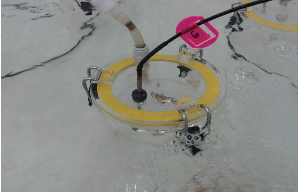
**Figura 7.-** *Amphiprion ocellaris* en la cámara respirométrica en donde se realizaron las evaluaciones de la TCO.
