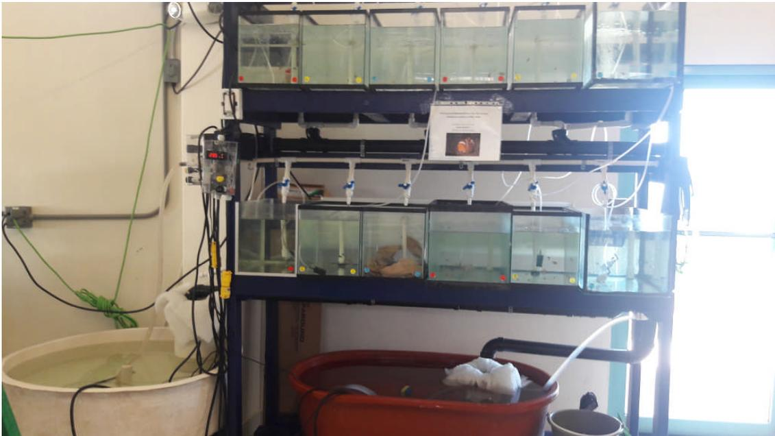
**Figura 12.-** Sistema cerrado utilizado en el experimento de bioenergética, consta de 2 niveles, cada uno cuenta con un filtro biológico y aireación constante. El sistema superior permaneció a una temperatura constante de  $23\text{ }^{\circ}\text{C} \pm 1$  y el sistema inferior a  $29\text{ }^{\circ}\text{C} \pm 1$
