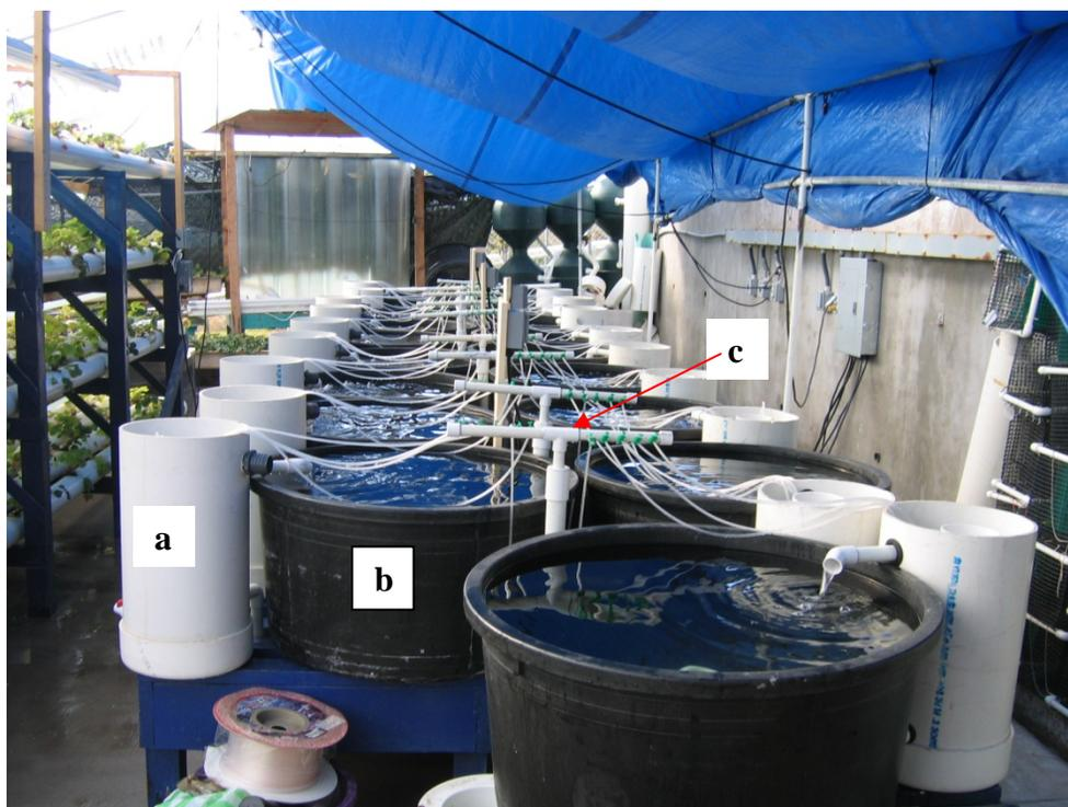
Figura 3. Diagrama del sistema de tanques y filtros que se utilizó para los experimentos de acondicionamiento y maduración de gónadas de reproductores de ostión japonés, a) bioclarificador, b) tanques de maduración, c) tubería de aire.
