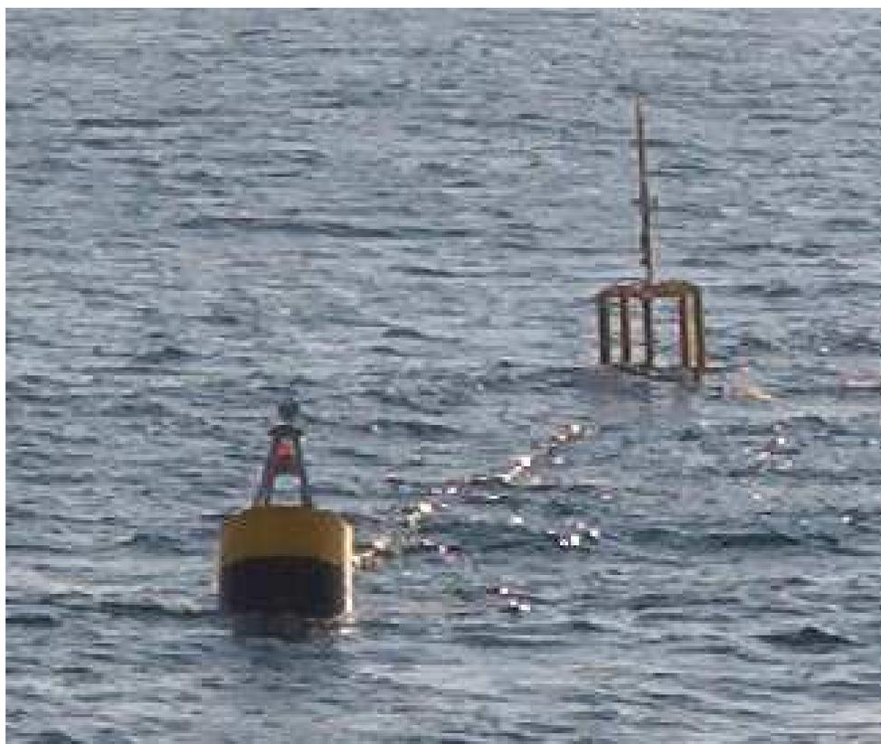
Figura 3: Fotografía del anclaje de la boya ASIS, con la boya de marcación en la parte inferior izquierda de la foto y la boya ASIS en la superior derecha.
