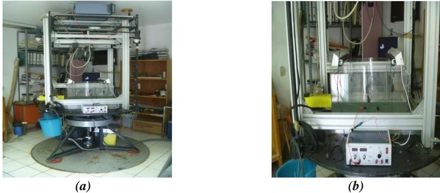
Fig. 30. Imágenes de (a) la mesa en rotación utilizada para generar el ambiente rotante y (b) montaje experimental.
