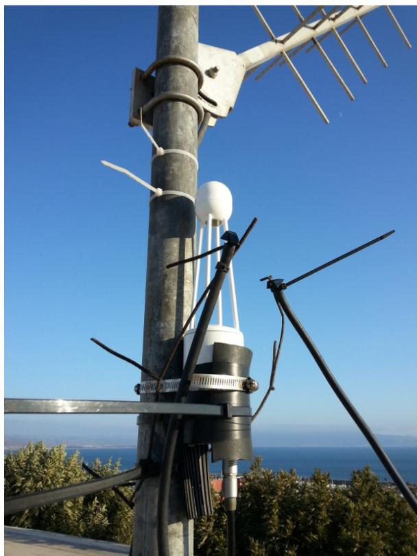
**Figura A2.** Sistema de limpieza implementado para reducir la contaminación en las lentes del analizador infrarrojo de gases.
