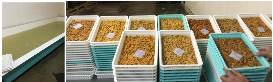
Figura 4. Proceso de extracción de gónada de erizo de mar. Se puede observar la piscina con las solución de aluminio, adentro se encuentran las charolas con gónadas (Izq.). Columnas de charolas drenando el agua de la solución de aluminio (Der.). Planta procesadora ISF Trading. Inc. Portland, ME. Tomada por Cuesta-Gomez (2016).
