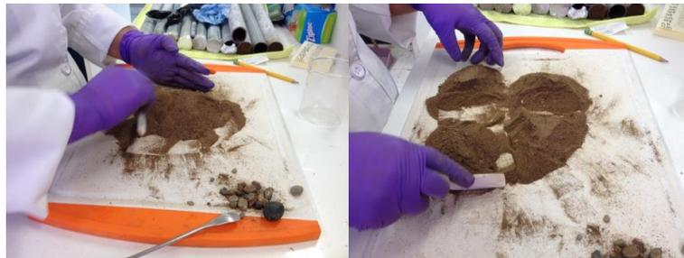
Figura 4. Procedimiento utilizado para la homogeneización y cuarteo de muestras.
