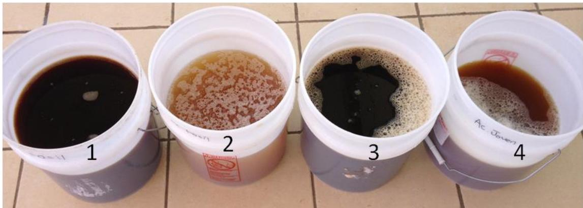
Figura 33. Lixiviado con  $C_6H_8O_7$  y KOH. Cubetas 1 (alcalino) y 2(ácido) guano fósil. Cubetas 3 (alcalino) y 4 (ácido) guano joven.
