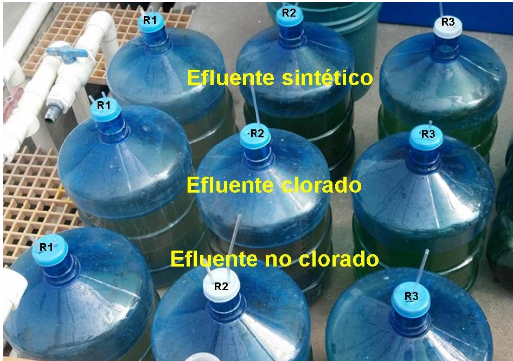
Figura 3. Tratamientos por triplicado para evaluar la capacidad removedora de nutrientes de C. vulgaris y S. obliquus en cultivo estático.
