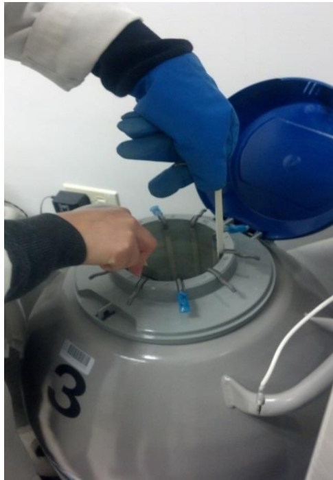
Figura 1. Congelación en nitrógeno líquido (-196°C) de las muestras filtradas para determinación proximal de C. vulgaris y S. obliquus .
