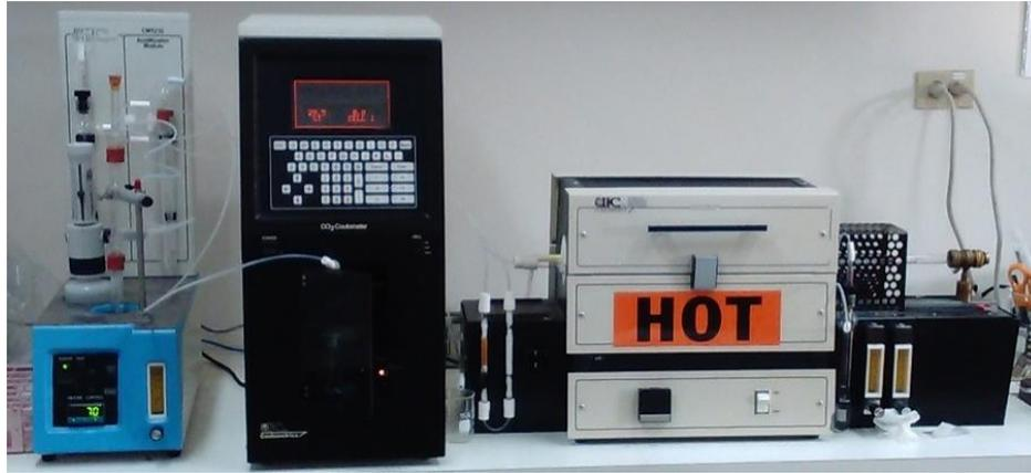
**Figura 3.** Coulómetro (equipo del centro) utilizado para la determinación de carbono total (módulo de combustión, lado derecho) y carbono inorgánico total (módulo de acidificación, lado izquierdo).
