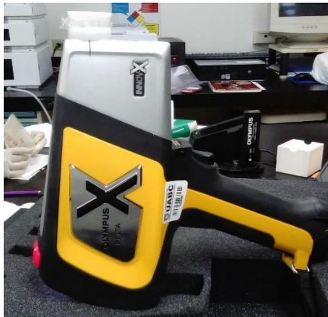
**Figura 2.** Análisis de una muestra de sedimento mediante Fluorescencia por Rayos X (XRF), usando el analizador portátil.
