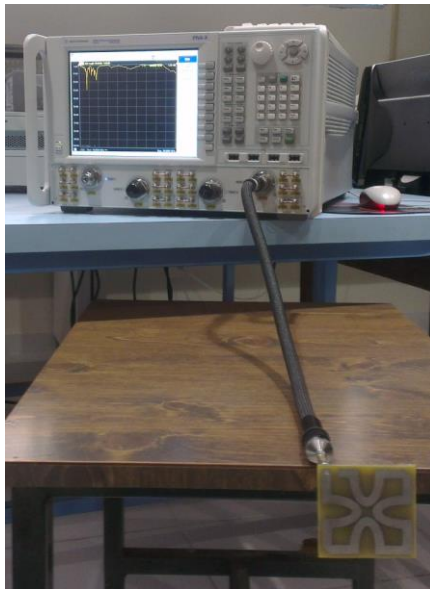
Figura 68. Medición de pérdidas por retorno ( S_{11} dB) de la antena fractal semi-elíptica.
