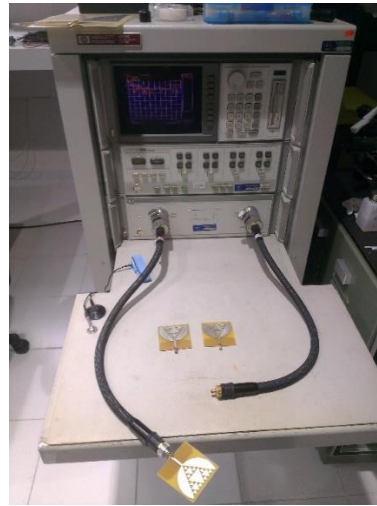
Figura 52. Medición de los parámetros S de la antena fractal de SWB.
