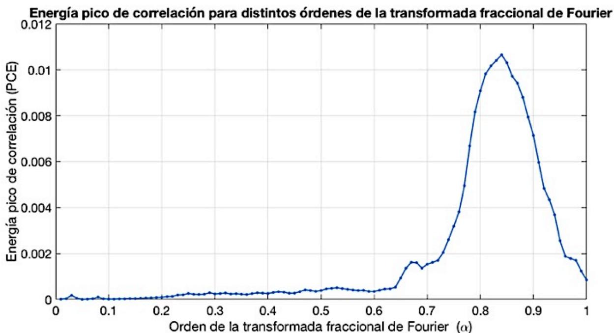
Figura 14. Cálculo del orden óptimo para la imagen IM\_E utilizando un filtro clásico.
