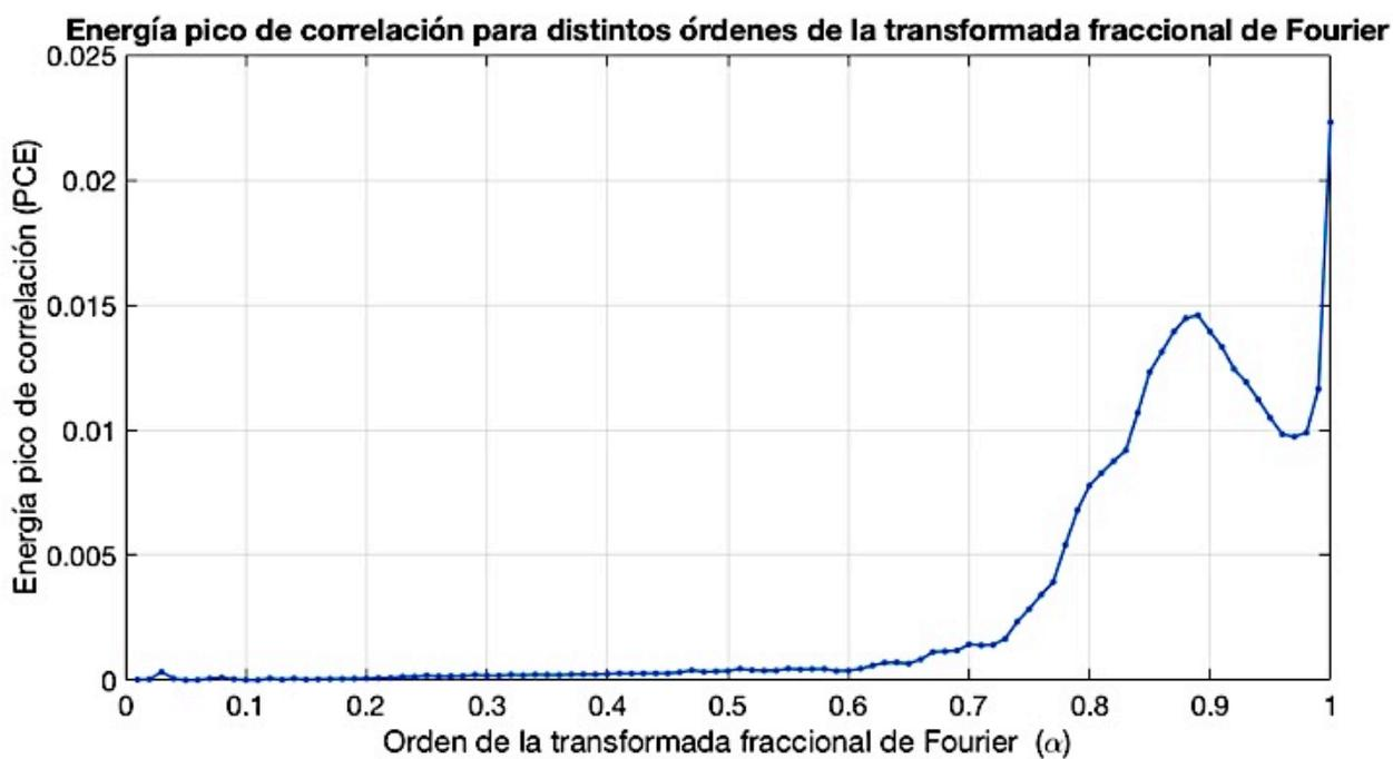
Figura 15. Cálculo del orden óptimo para la imagen IM\_E utilizando un filtro de fase.
