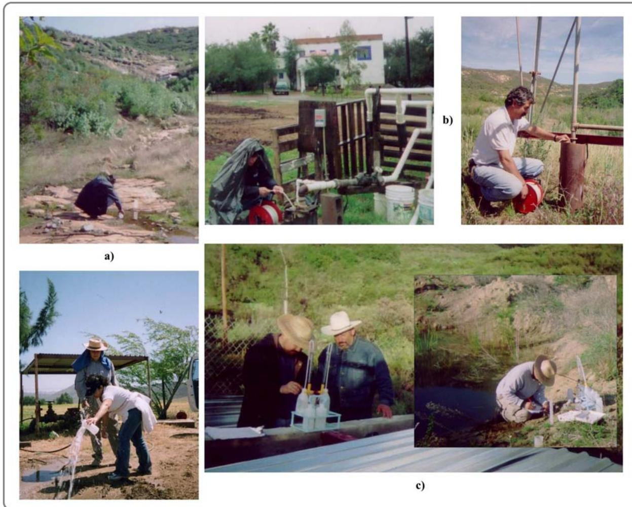
**Figura 25. Actividades realizadas en las campañas de muestreo. a) Recolección de muestras de agua, b) Medición de niveles freáticos y c) Obtención de los parámetros fisicoquímicos del agua**
