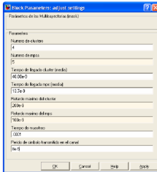
Figura 38. Ajuste de los parámetros de las funciones de densidad que definen las multitrayectorias.
