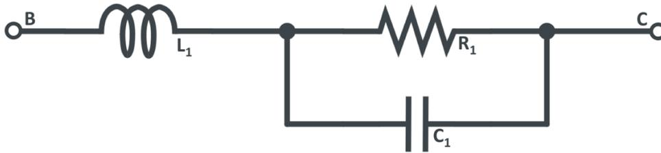
**Figura 40.** Circuito equivalente del elemento sensor
