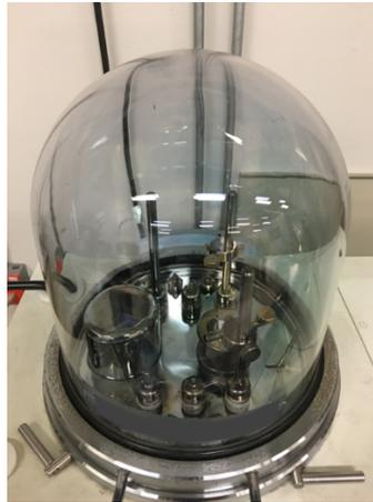
**Figura 22.** Fotografía de la cámara evaporadora
