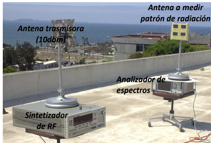
Figura 52. Banco de medición del patrón de radiación de las antenas planares de microcinta.
