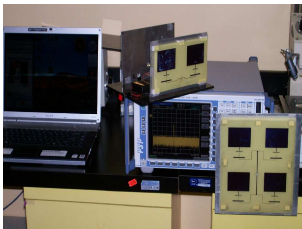
Figura 92. Configuración del experimento para medir los niveles de potencia emitidos por un PA y una PC.
