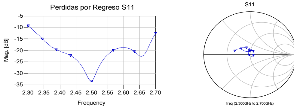
Figura 31. Comportamiento de la impedancia de 2.3 a 2.7 GHz de la antena de dos parches.
