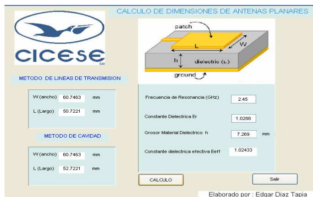
Figura 20. Interfaz Gráfica de la rutina en MATLAB para calcular las dimensiones de un parche.
