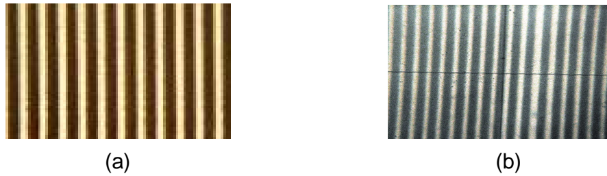
Figura 62: Secciones de una mascarilla (a) periódica y (b) aperiódica, vistas a través del microscopio.
