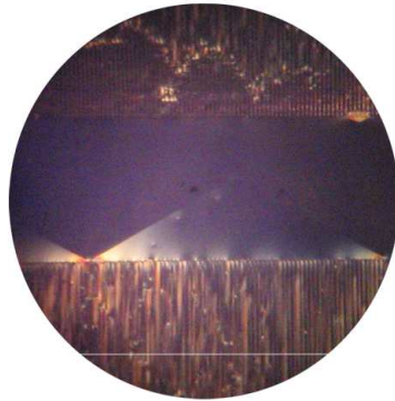
Figura 68: Dominios ferroeléctricos vistos a través del microscopio.
