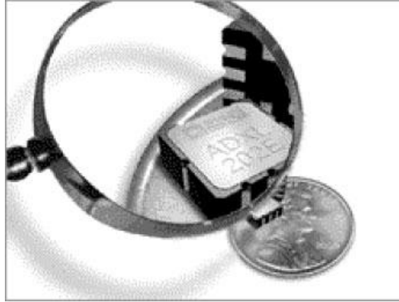
Figura 2. Acelerómetros para monitoreo del movimiento de las personas (Culhane, et al. , 2005).
