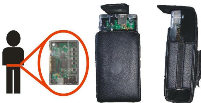
Figura 22. Colocación del sensor.
