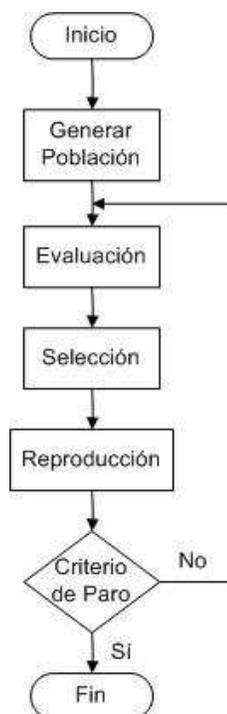
Figura 29: Diagrama de flujo general de un algoritmo evolutivo.
