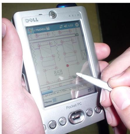
**Figura 15. Aplicación para Pocket PC con la que se hizo el registro de las intensidades de la señal de los diferentes puntos de acceso.**
