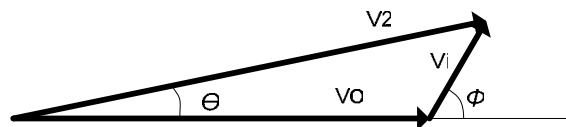
Figura 10: Representación fasorial para el encadenamiento cerca de la frecuencia de oscilación libre.
