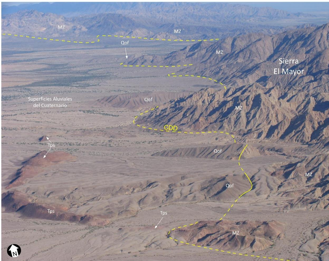
**Figura 10: Fotografía oblicua de la falla CDD.** La traza curvilínea de la falla maestra delimita el contacto litológico entre depósitos conglomeráticos del Plio-Pleistoceno (Qof) y superficies aluviales del Cuaternario (Qf) con el basamento cristalino del Mesozoico (Mz) de la Sierra El Mayor. Se observa además la presencia aislada de unidades de la Formación Palm Springs (Tps) y Qof levantando significativamente sobre las superficies aluviales del Cuaternario (Tomado de Vallín, 2017).
