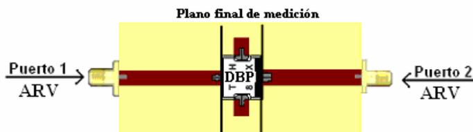
Figura 30. Base de pruebas útil en la caracterización de dispositivos no insertables
