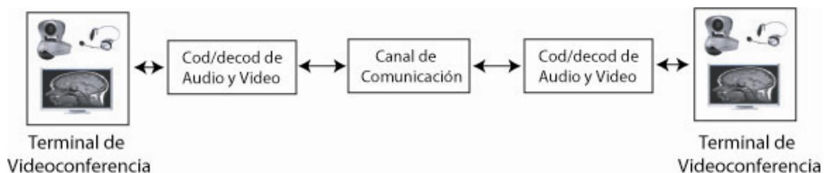
Figura 6. Componentes básicos de un sistema de Videoconferencia.
