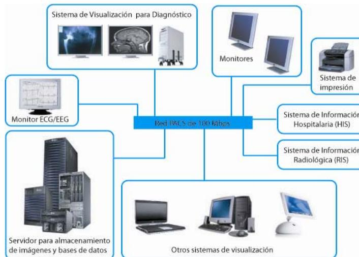
Figura 3. Componentes de un PACS [Huang, 2004].
