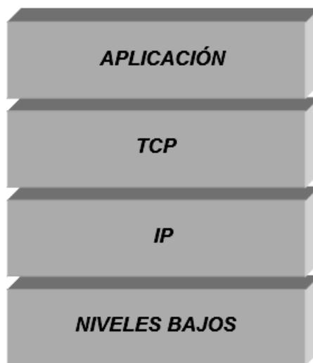
Figura 45. Modelo TCP/IP.
