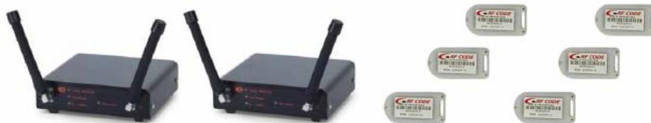
**Figura 16. Lectores RFID activos y tarjetas RFID activas utilizados por Landmarc.**
