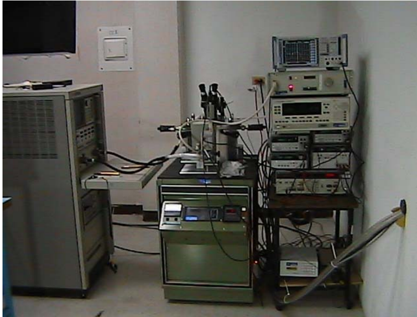
Figura 69. Banco de medición de ruido.
