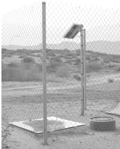
Figura 3. Nodo original de la RDEFVM. Se observa el panel solar, la tarjeta de adquisición a la izquierda y el sensor justo detrás del panel solar, ambos enterrados.
