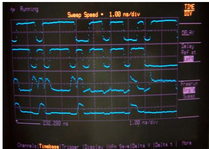
Figura 64. Imagen desplegada por la pantalla del osciloscopio de las señales de entrada y de los bits de signo y diferencia del restador.
