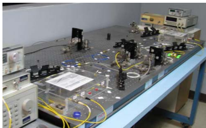
Figura 43. Imagen del banco experimental utilizado para la evaluación del restador en estado estático.
