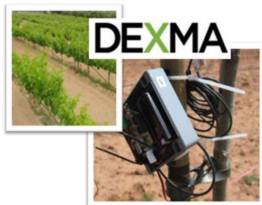
**Figura 8: Detalle de un nodo inalámbrico, desarrollado por Dexma.**
