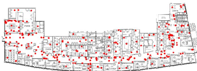
**Figura 26 Lecturas realizadas en el DCC durante la fase de medición de intensidad de señal**
