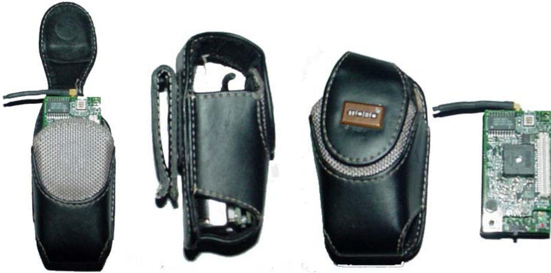
Figura 31 Acelerómetro utilizado para adquirir los datos.
