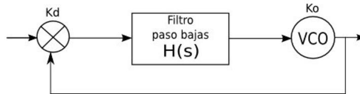
Figura 42: PLL equivalente para diseño de un lazo de Costas (Feigin, 2004)
