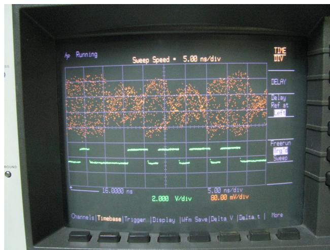
*Figura 82:* Señal de datos recuperada (superior), señal de datos del generador (inferior)
