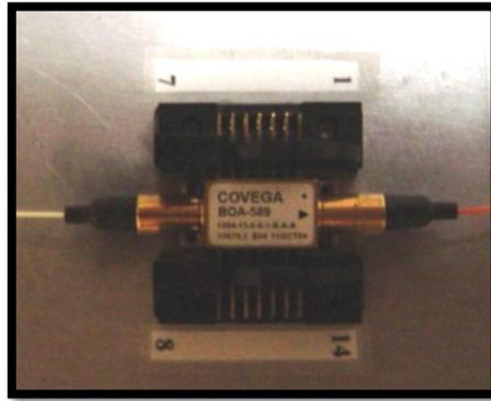
Figura 12. AOS empaquetado de tipo mariposa de 14 patas utilizado.
