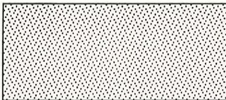
figura 1. Imagen de un patr3n de moteado formado por una superficie iluminada por un l3ser.
