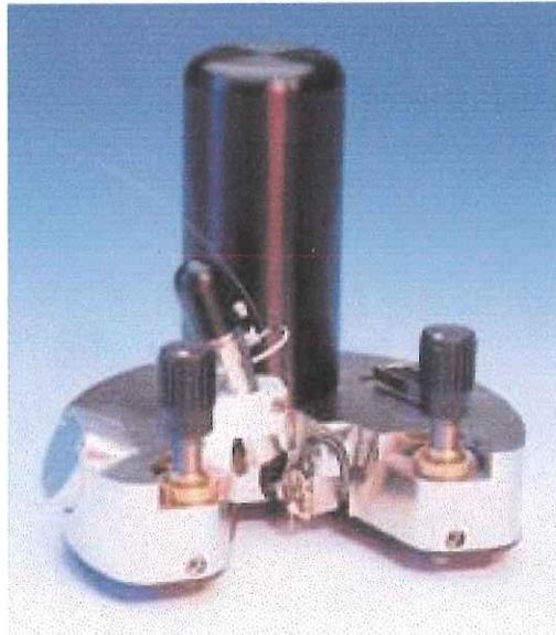
**Figura 4: Microscopio Aurora de Topometrix. (Foto cortesía de ThermoMicroscopes).**
