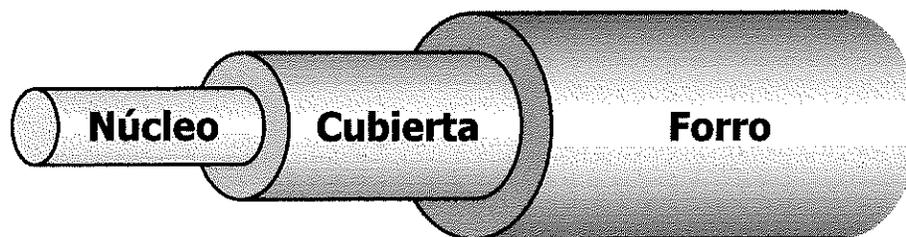
**Figura 7: Componentes de una fibra óptica. Las propiedades ópticas de la fibra dependen de las propiedades del núcleo y la cubierta, mientras que el forro sirve como protección.**
