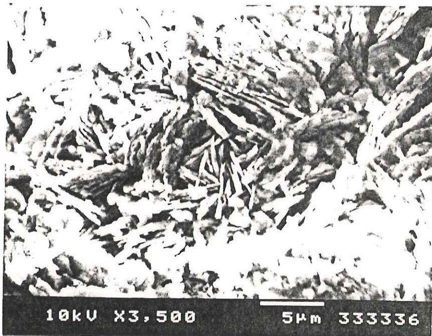
Figura 38. Micrografía SEM de la fase de aspecto filiforme o facetado tal como se observó a los 6 meses de exposición.
