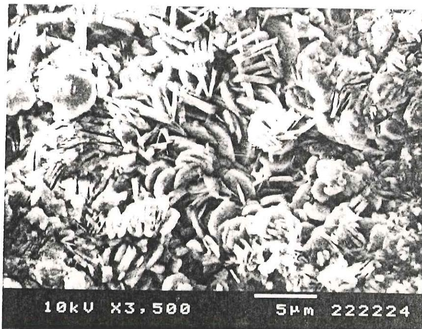
Figura 32. Micrografía SEM de la fase con aspecto filiforme o facetado tal como se observó a los 3 meses de exposición.
