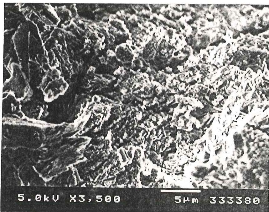
Figura 36. Micrografía SEM a los 6 meses de exposición en donde se observa, principalmente, una fase de aspecto granular.
