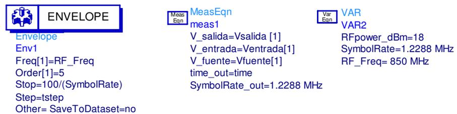
Figura 88. Controladores empleados en el linealizador de retroalimentación cartesiana lazo cerrado
