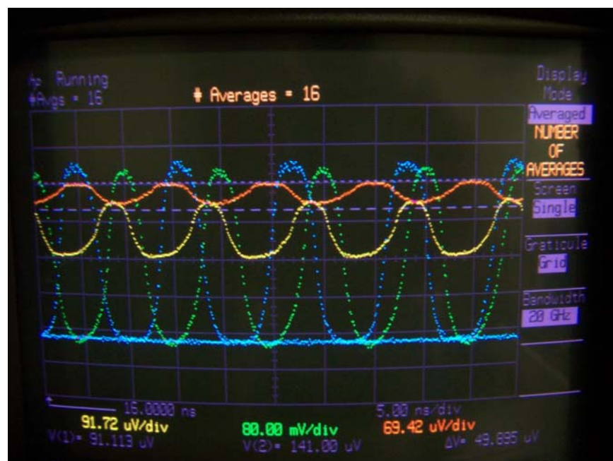
Figura 25. Algunas de las señales presentes en el experimento de la caracterización dinámica de la RNLP. Las señales moduladas en color azul y verde son aquellas introducidas al AOS cuyas frecuencias de modulación son las correspondientes a los límites inferior y superior del primer subintervalo (100 MHz - 6 GHz), respectivamente. La señal no modulada en color azul es una señal de referencia cuya potencia corresponde a la del nivel bajo de la señal modulada introducida al AOS. Las curvas amarilla y naranja representan las señales a la entrada y salida del polarizador 2, respectivamente.
