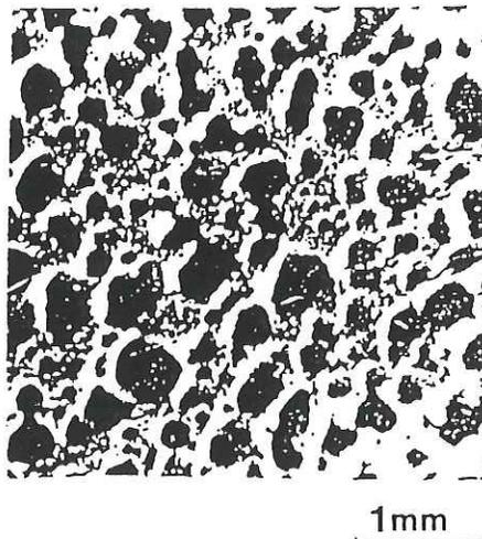
**Figura 37.** Estructura porosa lograda por burbujeo de peróxido de hidrógeno en una mezcla viscosa de polvos cerámicos (Ryshkewitch, 1953).
