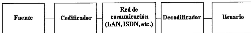
**Figura 2. Diagrama a bloques de un sistema de comunicación simplificado**
