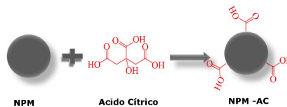
Figura 10 Molécula de ácido cítrico y su interacción con las nanopartículas magnéticas. Imagen tomada de (Cheraghipour, Javadpour, & Mehdizadeh, 2012)
