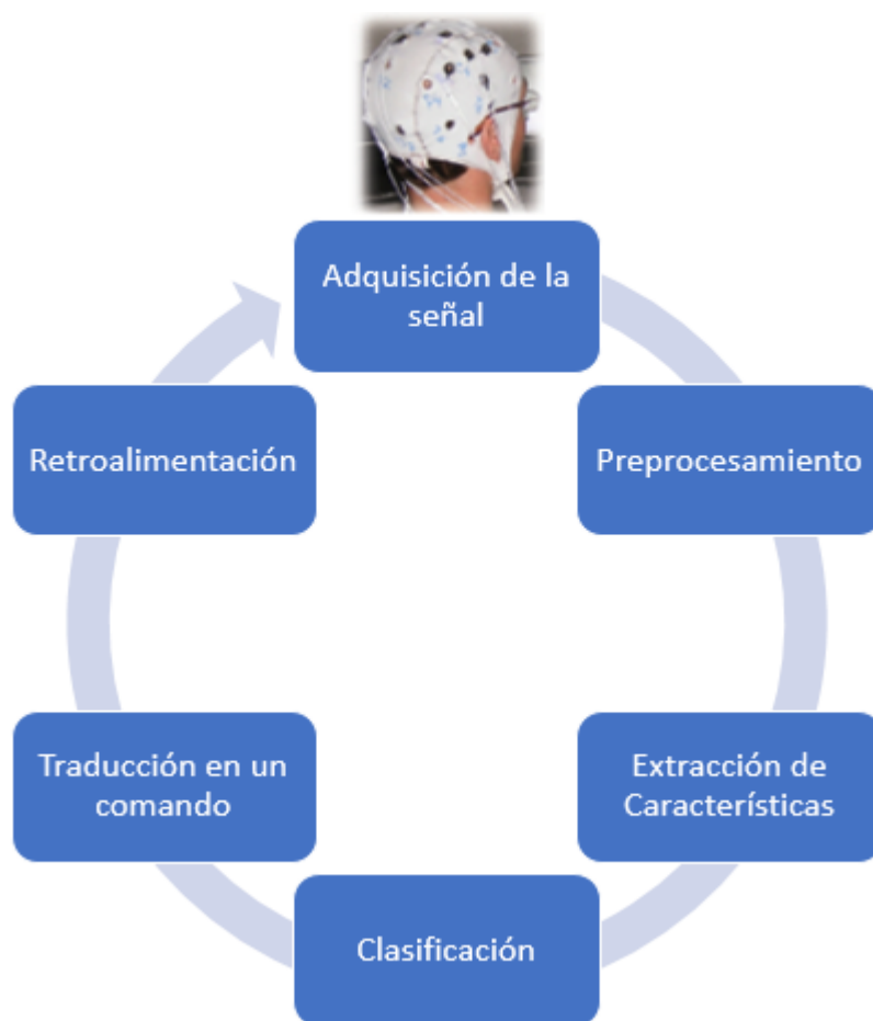
Figura 2. Elementos de una BCI
