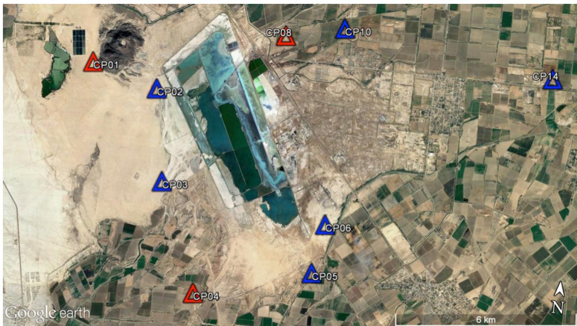
Figura 72. Estaciones de la RMEC-VMXL hasta Junio de 2016. Los triángulos en color rojo indican la posición de estaciones que dejaron de funcionar. Los triángulos azules indican la posición de estaciones que continúan en funcionamiento.
