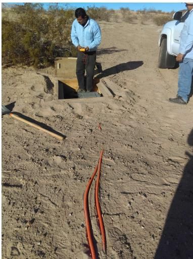
**Figura 29.** Estación de registro y mangueras de protección para los cables de los electrodos. En este caso, las mangueras fueron expuestas a la superficie por el viento en la estación CP01.
