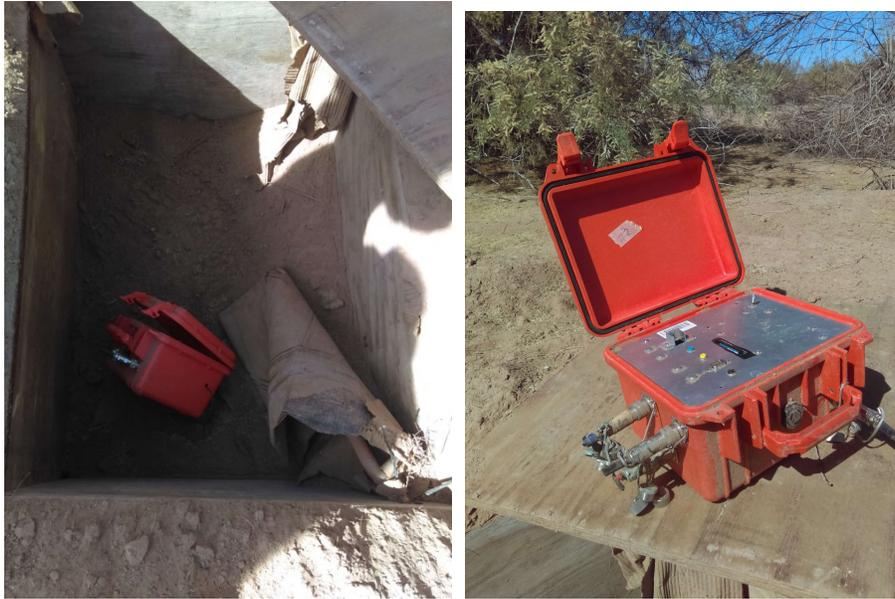
**Figura 33. Equipo de registro vandalizado en estación CP04. Los cables fueron cortados desde los conectores y estos fueron robados junto con las baterías de alimentación del equipo. La estación se encontraba totalmente expuesta al llegar al sitio.**
