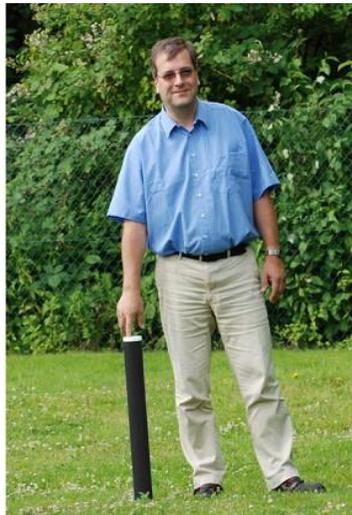
**Figura 10. Ejemplo ilustrativo de las dimensiones de una bobina de inducción MFS-07e (Metronix).**
