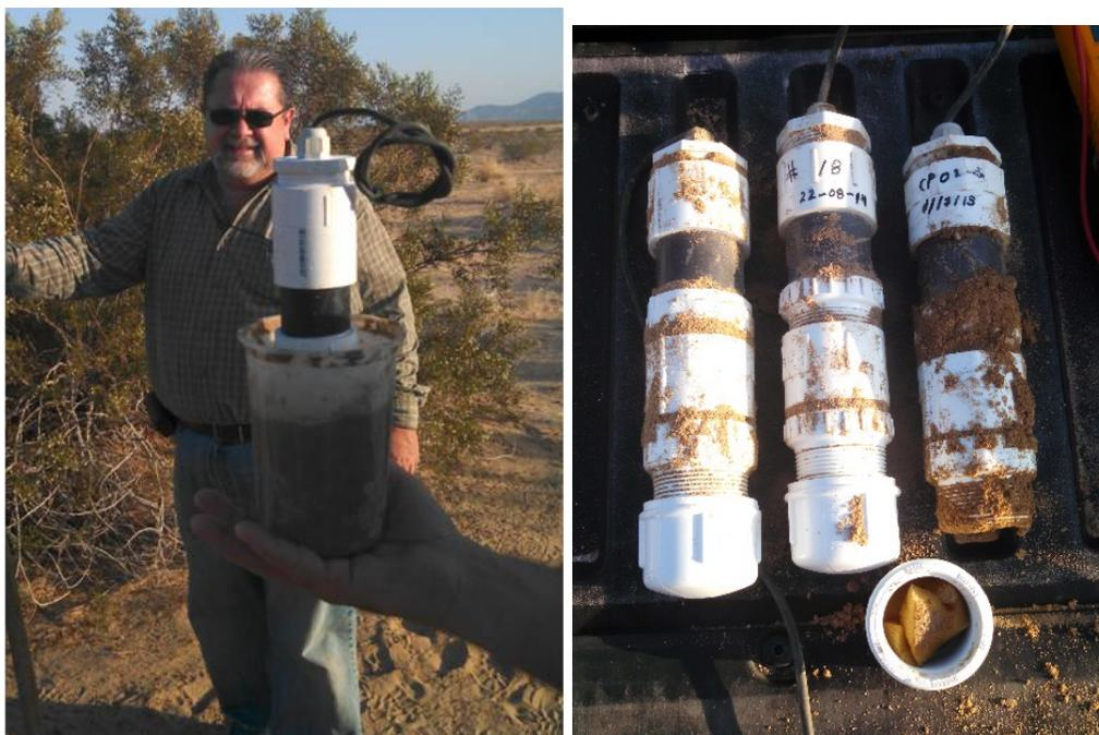
Figura 31. (Izquierda) electrodo listo para instalación con la configuración de “cubeta rusa”. (Derecha) ejemplo de electrodos reemplazados en el sitio CP02.
