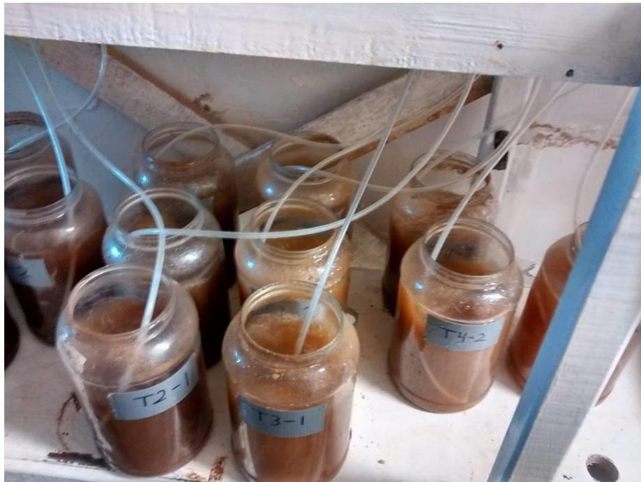
**Figura 6.** Activación de los probióticos en unidades de 1 L con aireación constante.
