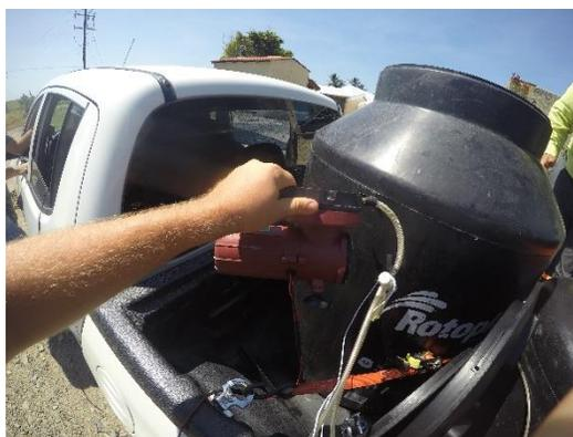
**Figura 1.** Sistema de aireación para transporte de tilapias.
