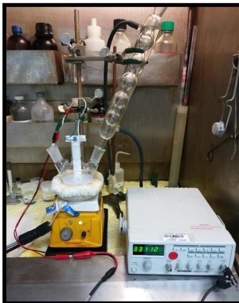
**Figura 18.** Sistema usado para el crecimiento de las nanocintas de HAp aplicando un campo eléctrico alterno de 3.3 kHz mediante una fuente generadora de pulsos.
