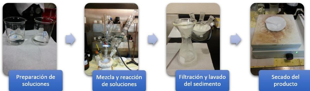
**Figura 16.** Diagrama del método hidrotermal utilizado para sintetizar las nanocintas de HAp.
