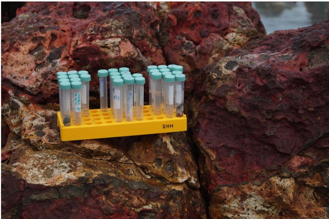
**Figura 5. Tubos de polipropileno con soluciones fijadoras (alcohol etílico al 96% y solución FAA), para las muestras de roca y agua de manantial antes de ser transportadas al laboratorio.**
