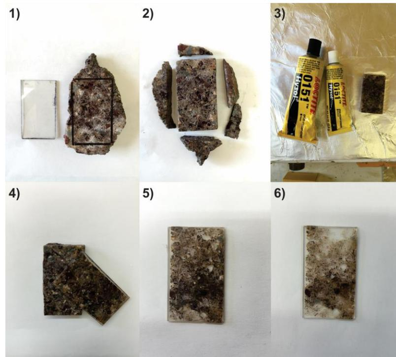
Figura 4. Procedimiento visual de los pasos realizados para la elaboración de las secciones delgadas de roca, de izquierda a derecha en 1) se puede ver la roca en su estado original y en 6) lámina delgada obtenida.
