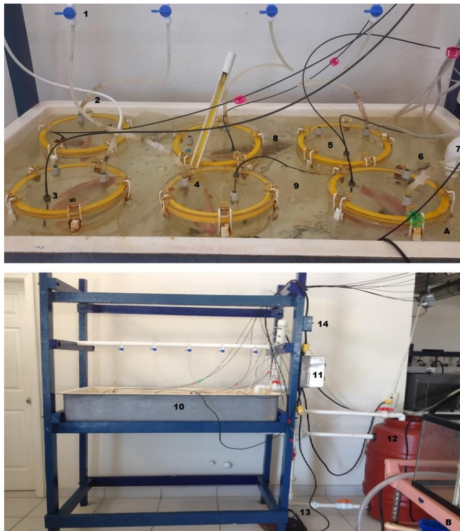
Figura 5. Determinación del consumo de oxígeno en juveniles de Pargo UNAM expuestos a diferentes temperaturas de aclimatación. A) fotografía de la parte interna del respirómetro: 1) válvulas que controlan el flujo del agua al interior de la CR, 2) válvula de entrada, 3) sensor óptico de oxígeno, 4) válvula de salida de agua y lugar de toma de muestra para amonio, 5) cámara respirométrica control, 6) tubo de nivel y drenaje de la tina de 100 L, 7) entrada de agua para liberación de parte del agua en la recirculación, 8) piedra de aireación para mantener la temperatura de agua homogénea y concentración de oxígeno, 9) baño de agua con temperatura controlada. B) fotografía externa del respirómetro: 10) tina rectangular de fibra de vidrio de 100 L, 11) controlador de temperatura, 12) reservorio de 200 L, 13) bomba periférica, 14) interruptor de corriente de la bomba.
